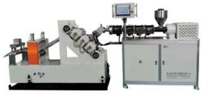
迷你三辊机 Mini three roll calender
